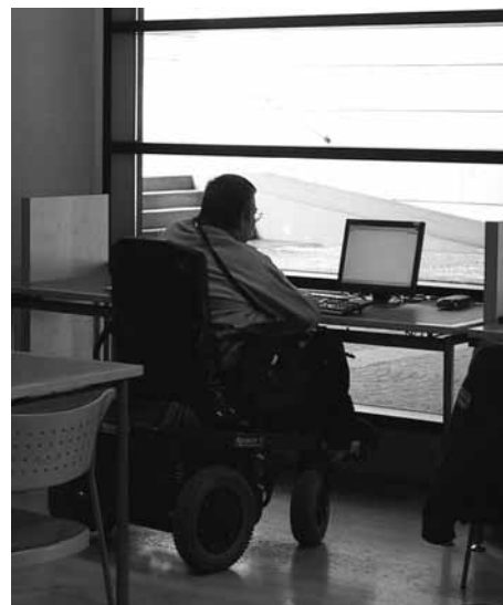
figura 322 L'altezza del tavolo deve consentire l'accostamento agevole di persone in carrozzina.
