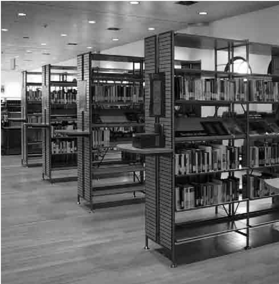
figura 286 Scaffalature a sistema scatolare puntiforme con struttura in acciaio, ripiani e pannellature in legno (Tecnocoop).
