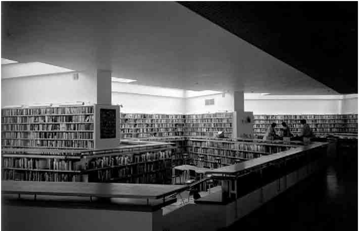
figura 273 Biblioteca civica di Rovaniemi. Le sale di lettura sono illuminate da finestre alte che consentono il massimo sfruttamento delle pareti per le scaffalature. La particolare conformazione dei lucernari diffonde la luce in modo soffuso nell'intero ambiente.
