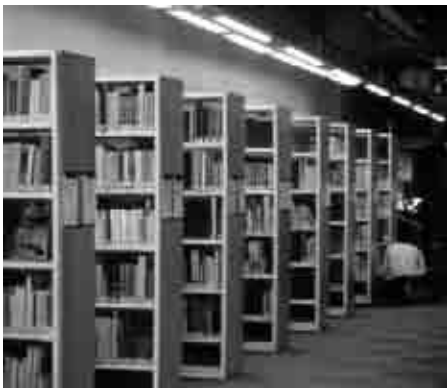
figura 227 Scaffalature nel magazzino aperto. Schema esemplificativo per il calcolo della superficie necessaria per la conservazione dei volumi nel magazzino a scaffale aperto. Gli scaffali possono essere posti a 120-150 cm di distanza, o anche a meno nel caso in cui lo spazio a disposizione non fosse abbastanza. Nel caso in cui i corridoi tra gli scaffali fossero più stretti di 150 cm è necessario diminuire la lunghezza per avere zone di ampiezza tale da consentire la rotazione di una carrozzina (preferibilmente lunghezze non maggiori di 5 m).
