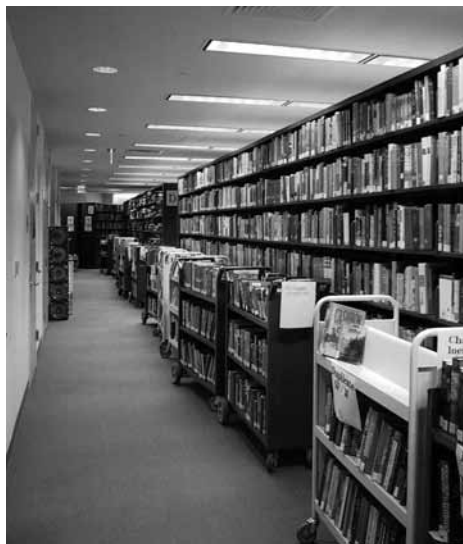
figure 229-230 Scaffalature nel magazzino chiuso. Schema esemplificativo per il calcolo della superficie necessaria per la conservazione dei volumi nel magazzino a scaffale chiuso. Gli scaffali possono essere posti a 90 cm di distanza, o anche a meno, nel caso fosse necessaria una maggiore densità.
